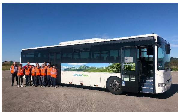
Car Iveco Crossway rétrofité en essais de roulage sur piste ©GREENMOT
